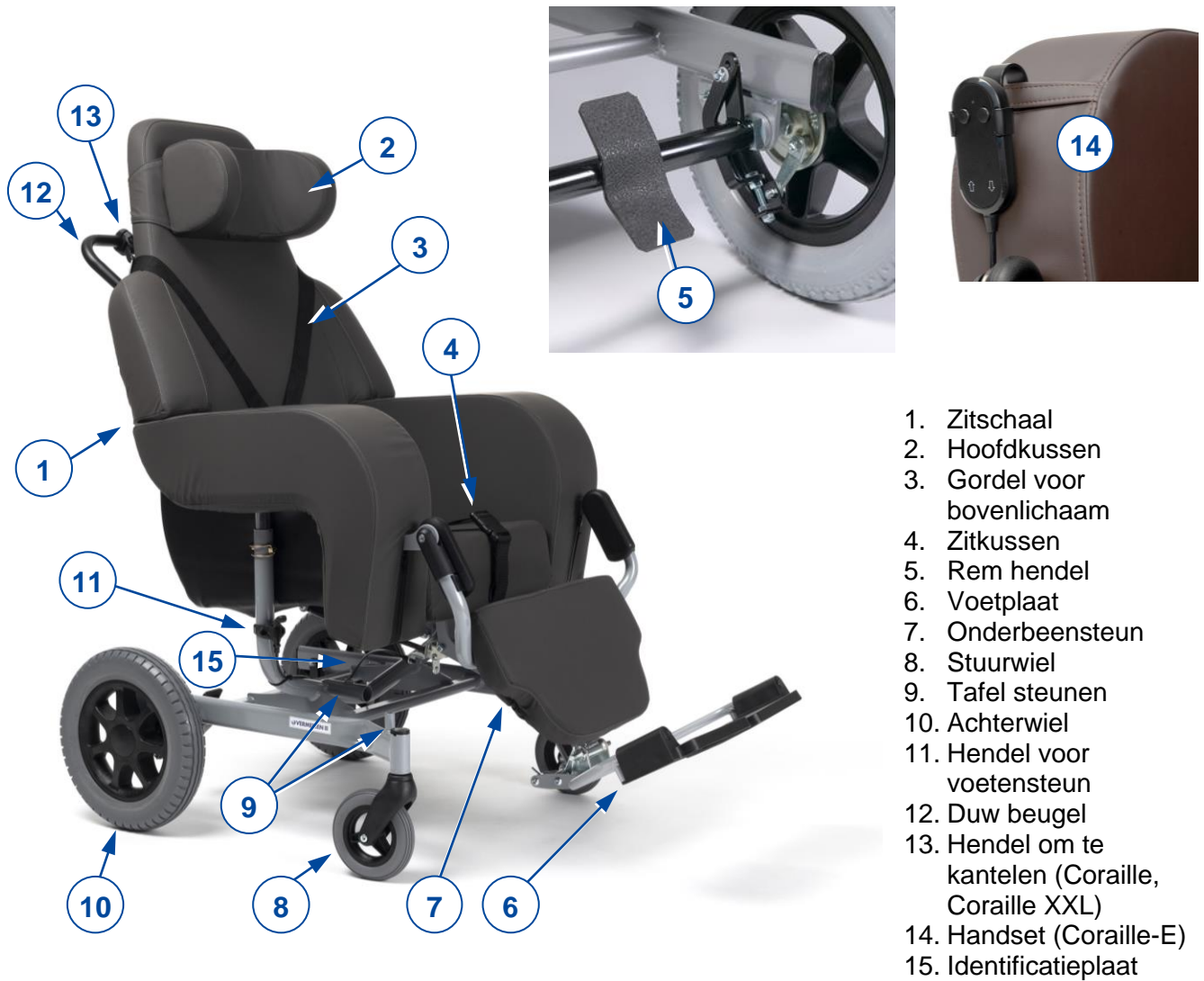
Figuur 2 Belangrijke onderdelen, Coraille, Coraille-E, Coraille XXL
