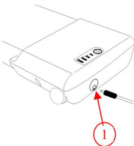
Pour garantir la pleine capacité de la batterie, chargez-la complètement à l'aide du chargeur avant de l'utiliser pour la première fois. La batterie peut être rechargée à tout moment sur le fauteuil roulant ou lorsqu'elle est retirée du fauteuil.
