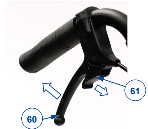
Figuur 5 De trommelremmen bedienen
