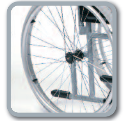
Achterwielen voorzien van het Quickrelease systeem
